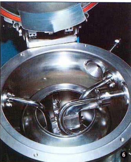
Centrifugal Decanter type DRC 40 AV 15 with electropolished bowl with removable blades Dekantierzentrifuge Typ DRC 40 AV 15 mit abnehmbaren Einbauten, anodisch poliert
