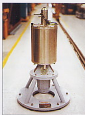
Extracteurs centrifuges multi-étages. Multi-stage centrifugal extractors.
