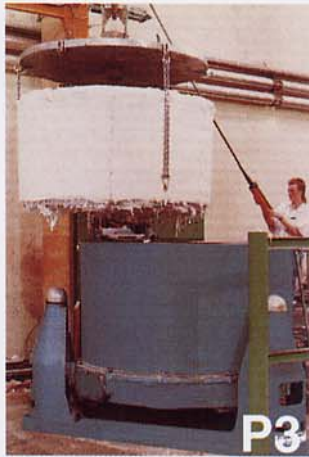
Centrifugación placa de fondo y cadenas para bloques de borras en salida del autoclave. Tipo KGA.
