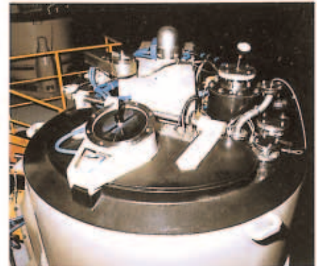
Hidroextractor centrífugo con cuba de pequeña abertura y revestimiento HALAR.
