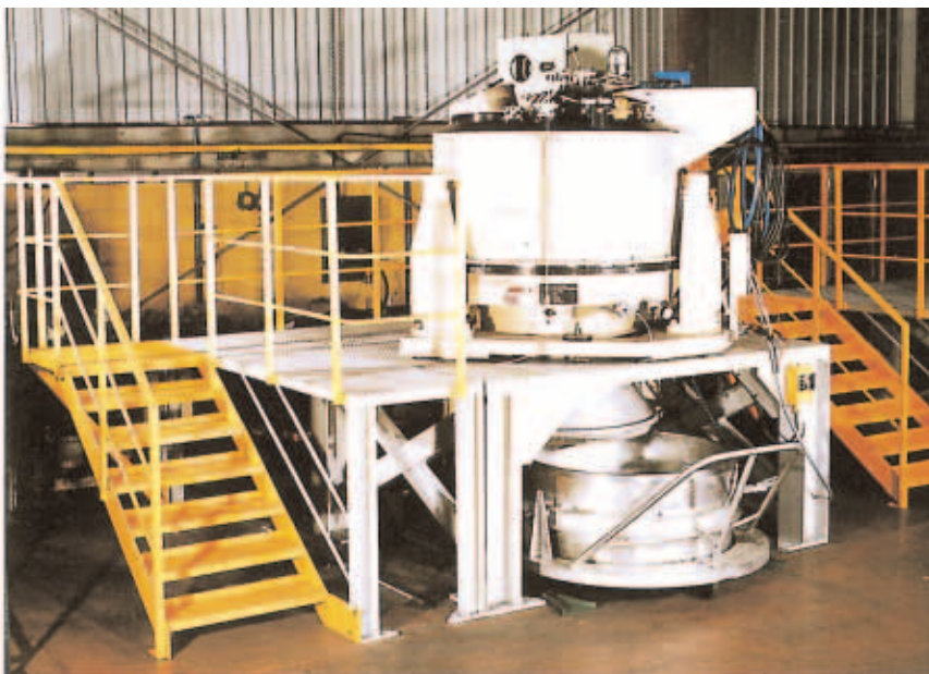
Hidroextractor con descarga por el fondo tipo SC 120 Vx DEC-R sobre plataforma y container estanco para recuperación del producto escurrido.
