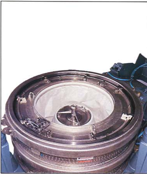
Saco semi-automático montado sobre su corona y posicionado en el hidroextractor.
