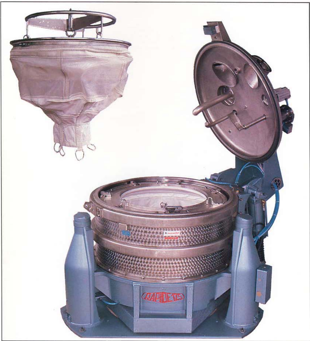
Saco de filtración con apertura y cierre manuales.
